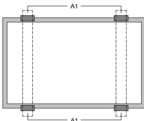
Posizionamento barre di fissaggio ad una distanza min 860mm/max 1300mm tra di loro(A1).
