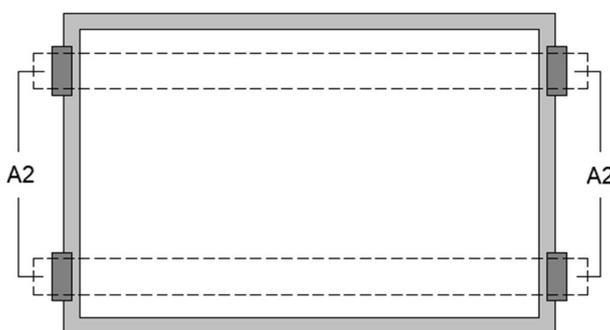
Posizionamento barre di fissaggio ad una distanza min 540mm/max 710mm tra di loro(A2).
